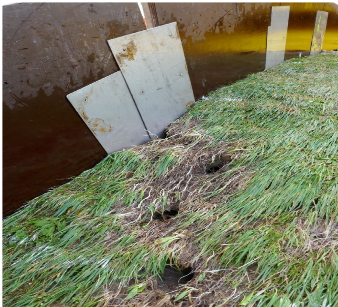
Figuur 7 De molsgaten waren na 5 stormuren met een overslagdebiet van 1 l/s per m goed zichtbaar geworden [Infram, 2021]
