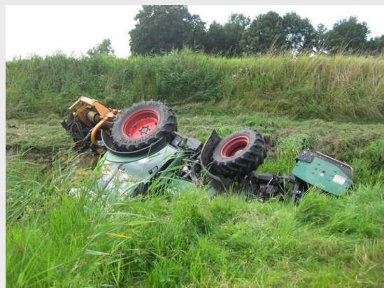
Figuur 3.5 Als gevolg van graverijen omgevallen trekker bij maaiwerkzaamheden (bron en locatie onbekend).
