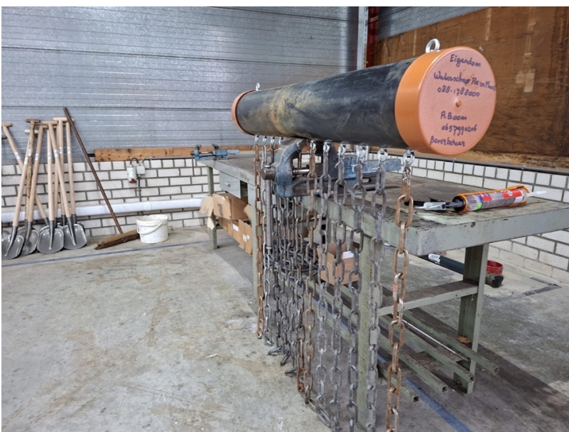
Afbeelding 10: Mobile drijver met zware kettingen
