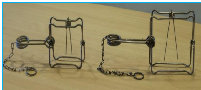
Afbeelding 7: Conibearklem links de 110 en rechts de 150. Goed zichtbaar is de V-vormige triggermechanisme (Foto: onbekende maker, z.d)
