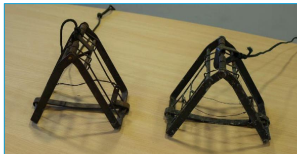
Afbeelding 9: Grondklem in verschillende maten. Zichtbaar is het tweedradige triggeringsmechanisme (foto, onbekende maker, z.d).
