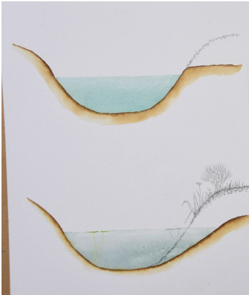
Figuur 5. Boven: het verlagen van een oever om deze voor bevers minder aantrekkelijk te maken om in te graven. Onder: het verflauwen van een oever om deze voor bevers minder aantrekkelijk te maken om in te graven. Deze optie is met name geschikt als er meer ruimte is om de oever aan te passen.
