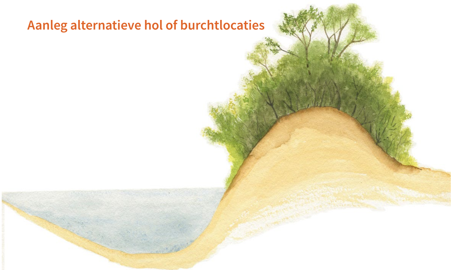
Afbeelding 1. Schematische tekening van een geschikte oever, met een relatief steil talud dat onder water steil doorloopt, een relatief hoge oever en met houtige begroeiing op die oever (D. Klees).
