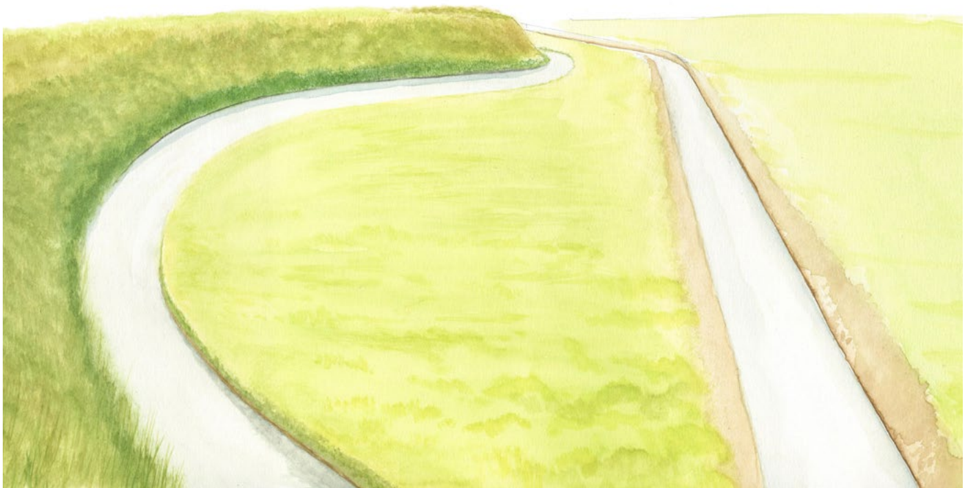
Afbeelding 1. Weergave van de ligging van een watergang voor (links) en na (rechts) het verplaatsen van die watergang om te voorkomen dat bevers in de voet van een waterkering graven. De oude watergang wordt gedempt na aanleg van de nieuwe loop (D. Klees).
