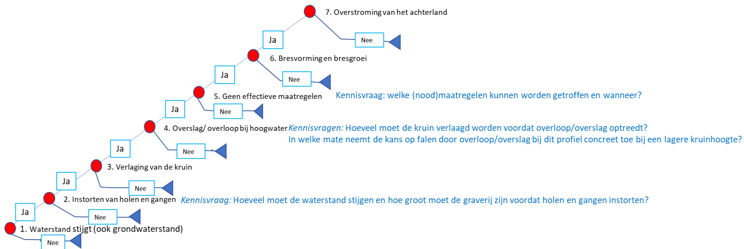
Figuur 2.6 Faalpad bevergraverij op (gebrek) aan hoogte
