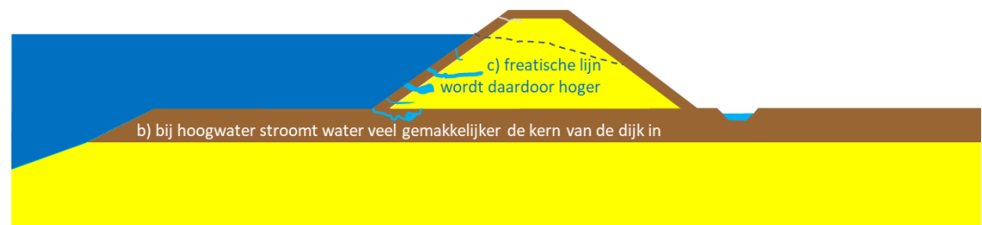
Figuur 2.12 Buitendijkse graverijen: sterkere indringing van water in de kern van de dijk bij hoogwater
