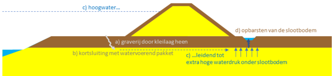
Figuur 2.16 Buitendijkse graverij door middelgroot of groot dier, eerste vier stappen
