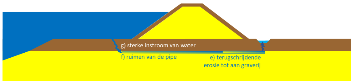
Figuur 2.17 Buitendijkse graverij, vervolgstappen met piping inclusief ruimen van de pipe
