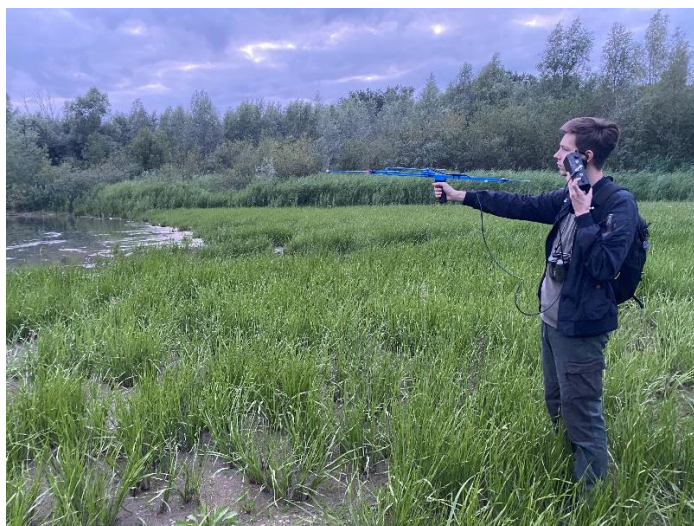
Figuur 3. Uitvoering van VHF-telemetrie in 'Het Engelse Werk'. Op de afbeelding wordt een antenne uitgestoken en met behulp van een ontvanger geluisterd naar het radiosignaal om de locatie van een gezenderde bever te bepalen. (eigen foto)
